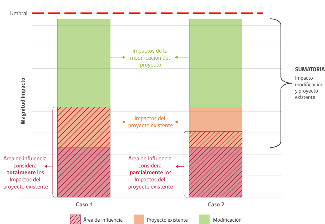
Figura 8. Condición de un objeto de protección en una determinada área de influencia respecto a la combinación de los impactos del proyecto existente y su modificación o etapas posteriores
